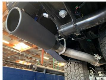
7. INSTALL DRIVER SIDE TAILPIPE HANGER BY SLIDING THE SIDE WITH THE HOLE BETWEEN THE TWO TABS WITH HOLES THAT PROTRUDE FROM THE FRAME JUST ABOVE THE DRIVER SIDE EXIT PIPE LOCATION. NEXT, INSTALL EXIT PIPES USING BAND CLAMPS.
