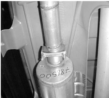
NOW, INSTALL THE HEADPIPE #A ON TO THE FACTORY FLANGE USING FLANGE #F. DO NOT TIGHTEN. INSTALL THE MUFFLER # B WITH INLET FACING FORWARD. MUFFLER INLET IS LOOKING INTO THE LOUVERS. THE MUFFLER OUTLET WILL BE POSITIONED AT ABOUT 6 O'CLOCK.
